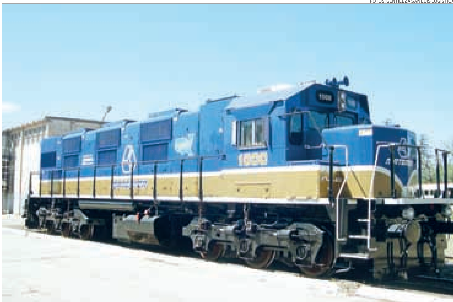
Gran potencia. La locomotora Nviromotive modelo 3GS24C tira hasta 60 vagones y alcanza 120 kilómetros por hora. Tiene tres motores diesel y 2.400 caballos.
